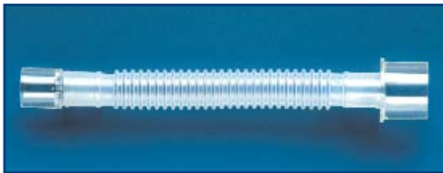
Soft-Flex livré avec bouchon de protection rouge, Connecteurs: côté patient 15 F côté machine 22 F
